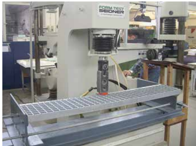
Bild 31: Prüfanordnung vor Lasteinleitung
